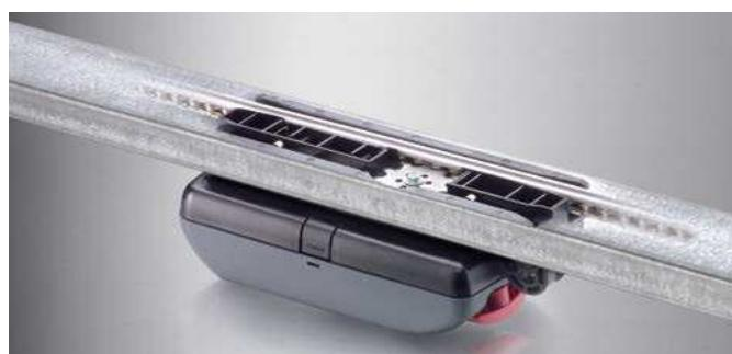
O motor corre directamente sobre a corrente que está fixa ao contrário de outros modelos de automatismos em que a tração e deslocação do portão é efetuada através da corrente, evitando maior ruído e desgaste.
